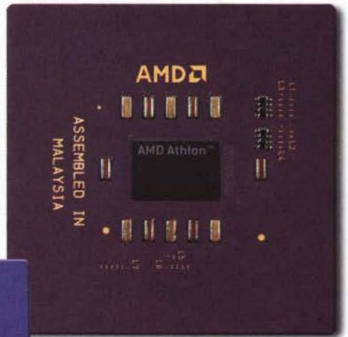
AMD Athlon e AMD Duron: la differenza tecnologica -praticamente ridotta alla cache interna- è evidenziata dalla somiglianza esterna, laddove solo la colorazione sembra distinguere un processore dall'altro.
